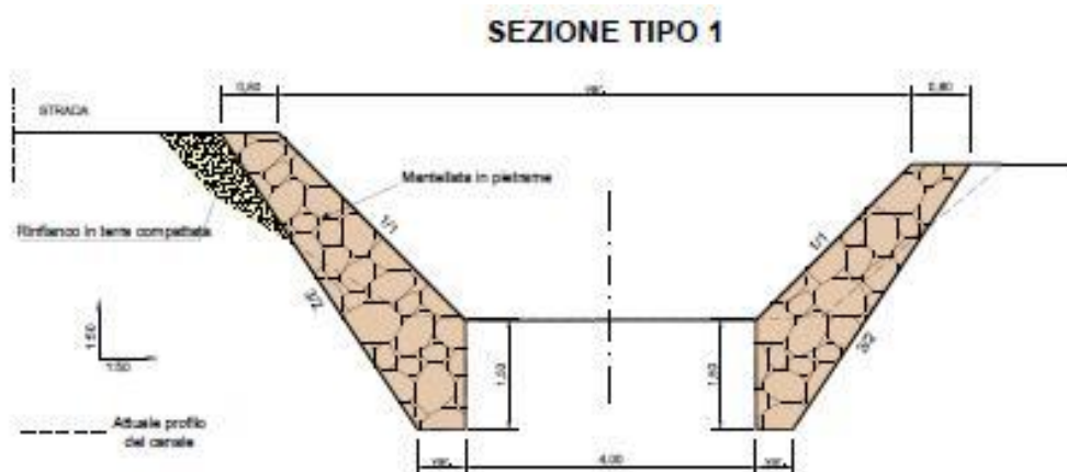
Sezione tipo dell'intervento
